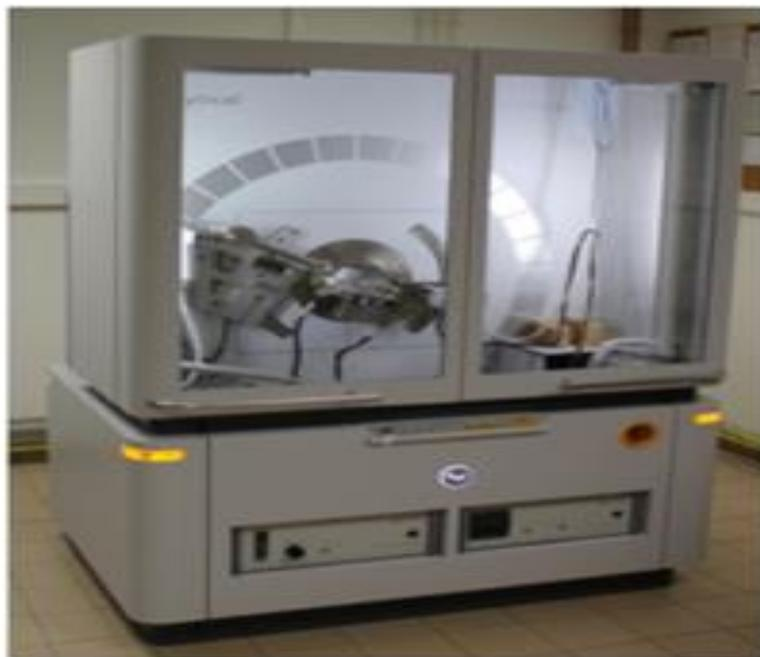
4. appareil de diffraction par rayon X (DRX)
