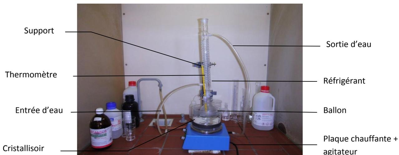
**Figure II-2.** Dispositif expérimental utilisé pour la préparation du sol-gel
