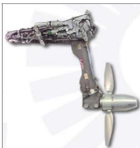
**Figure I-5:** Photographie de la RAT pour A330 et A340
