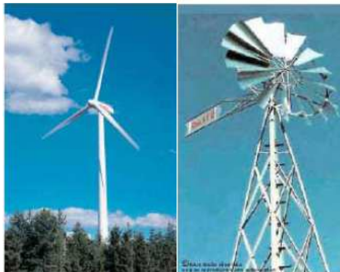
Fig. I. 4 Eoliennes à axe horizontal
