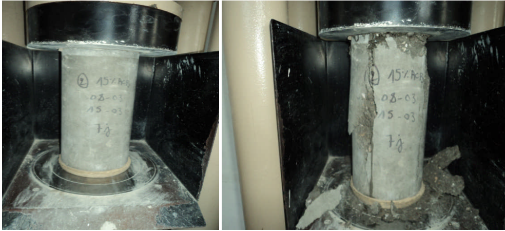
Figure 35. Essai d'écrasement d'une éprouvette de BAP(15) à l'âge de 7 jours.
