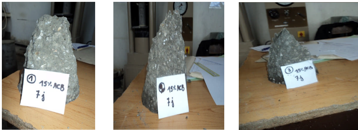
Figure 36. Les trois morceaux obtenus après l'écrasement des trois éprouvettes de BAP(15) à l'âge de 7 jours.
