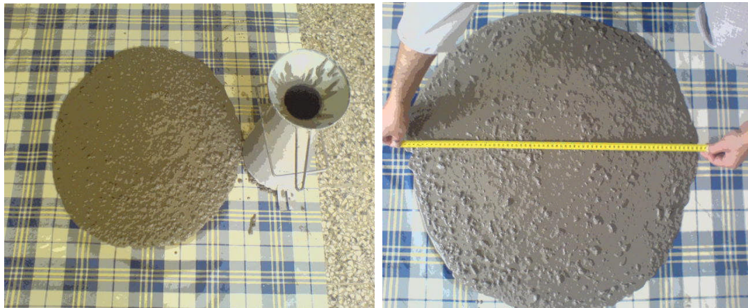
Figure 31. Essai d'étalement des bétons autoplaçants.
