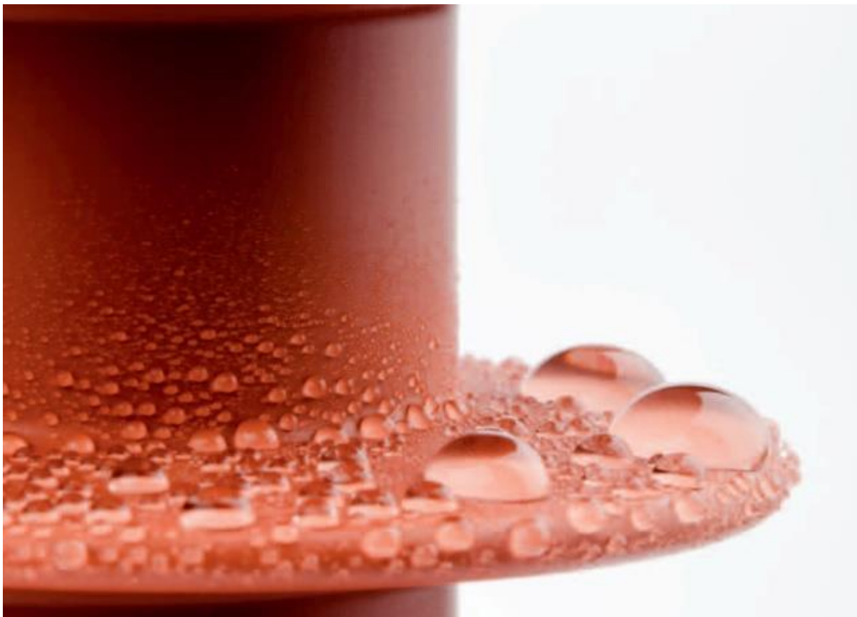
Figure II.3 : hydrophobicité d'une silicone
