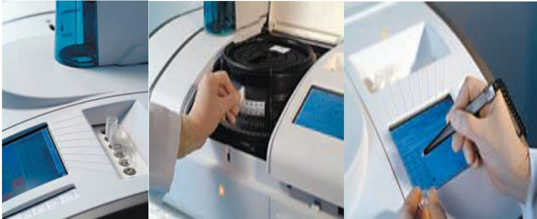
Figure 13 : Etapes du dosage automatique par Cobas C111 (ROCHE DIAGNOSTICS).
