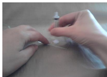
Figure 30: Ecrasement d'échantillon a l'aide d'une seringue.
