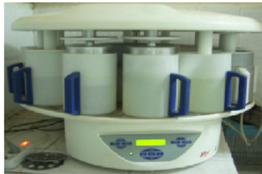
Figure 16: Les étapes d'inclusion par l'automate (STP 120) (Parnet, 2013)
