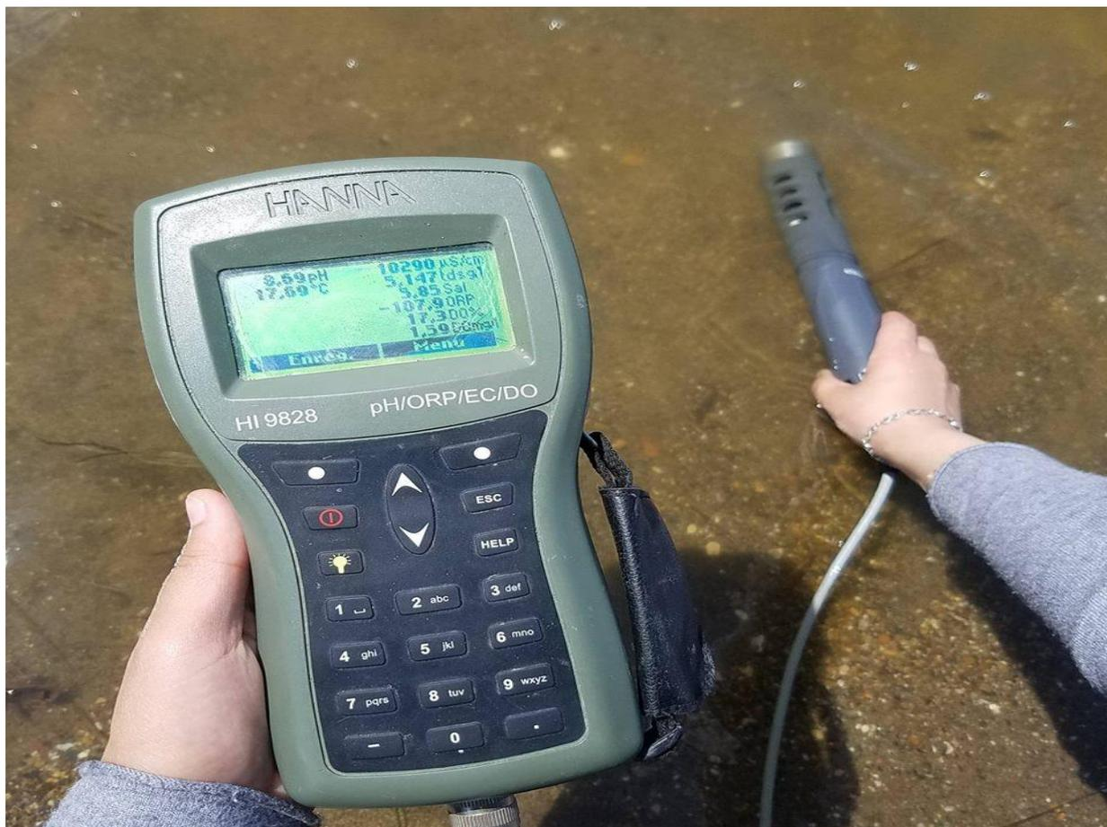
**Figure 12:** La mesure des paramètres physico-chimiques in-situ (photo prise le 10 /05/2018)
