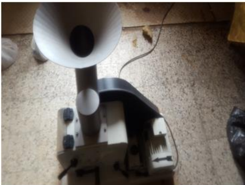
Figure III 08 : Concasseur à mâchoire.
