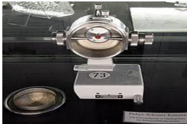
Figure II. 5 : Montage de Debye Scherrer.
