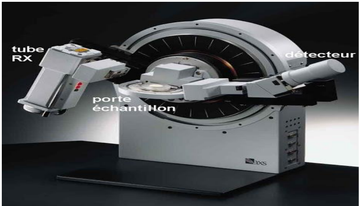
Figure II. 3 : Montage de Bragg Brentano.
