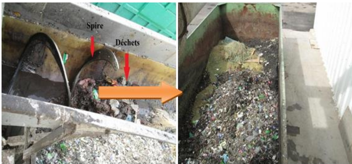
Figure 4. L'évacuation de déchets vers les bennes de décharge [11]
