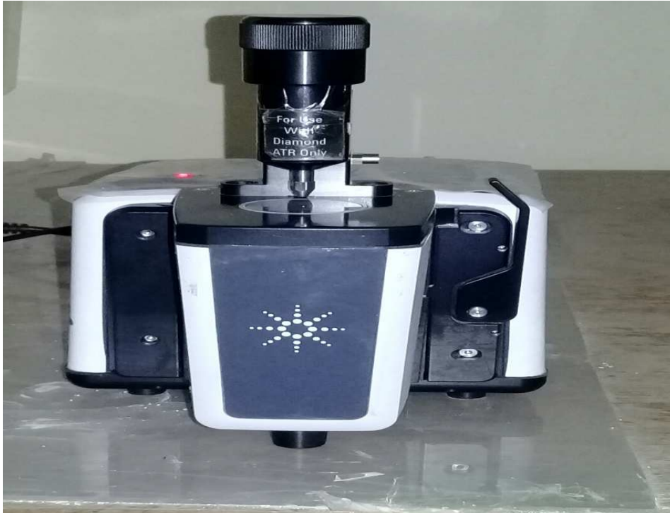
Figure II.9 : Photographie de l'appareil FTIR de type Cary 630 d'Agilent Technologies pour l'identification des groupements fonctionnels.
