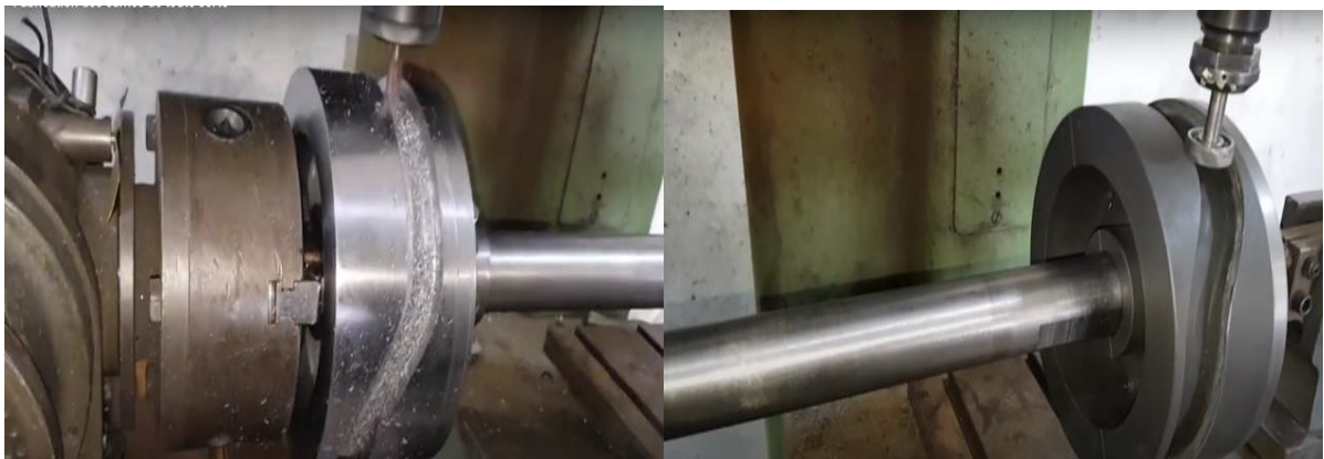
Figure II.21 Exemple d'usinage d'une came à rainure.
