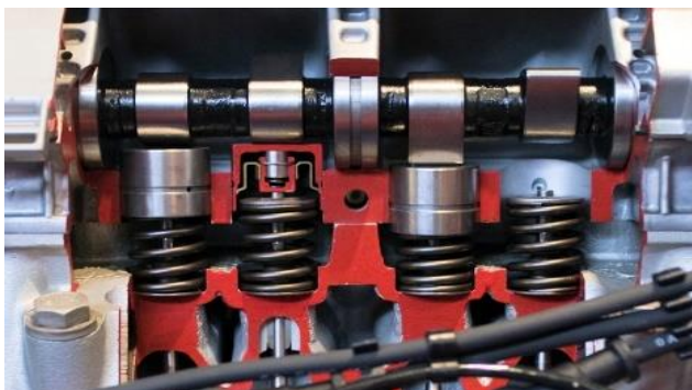
Figure II.12 Mécanisme à came dans un moteur à combustion interne.
