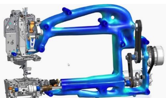
Figure I.5 Une machine à coudre fabriquée à l'aide de design génératif.
