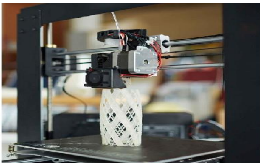
Figure I.7 Une pièce complexe réalisée à l'aide d'une imprimante 3D.
