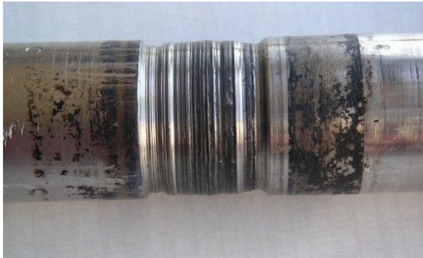
Figure 05 : L'usure par adhérence
