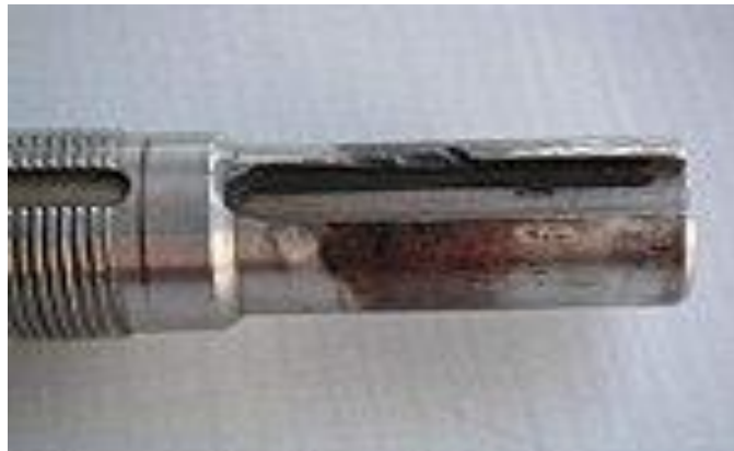
Figure 06 : L'usure par corrosion
