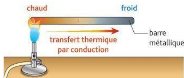
Figure I .13 Transfert de chaleur par conduction
