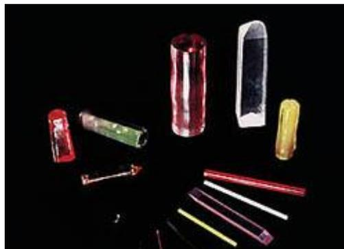
**Figure I.10** Tiges de Nd:YAG pour lasers.
