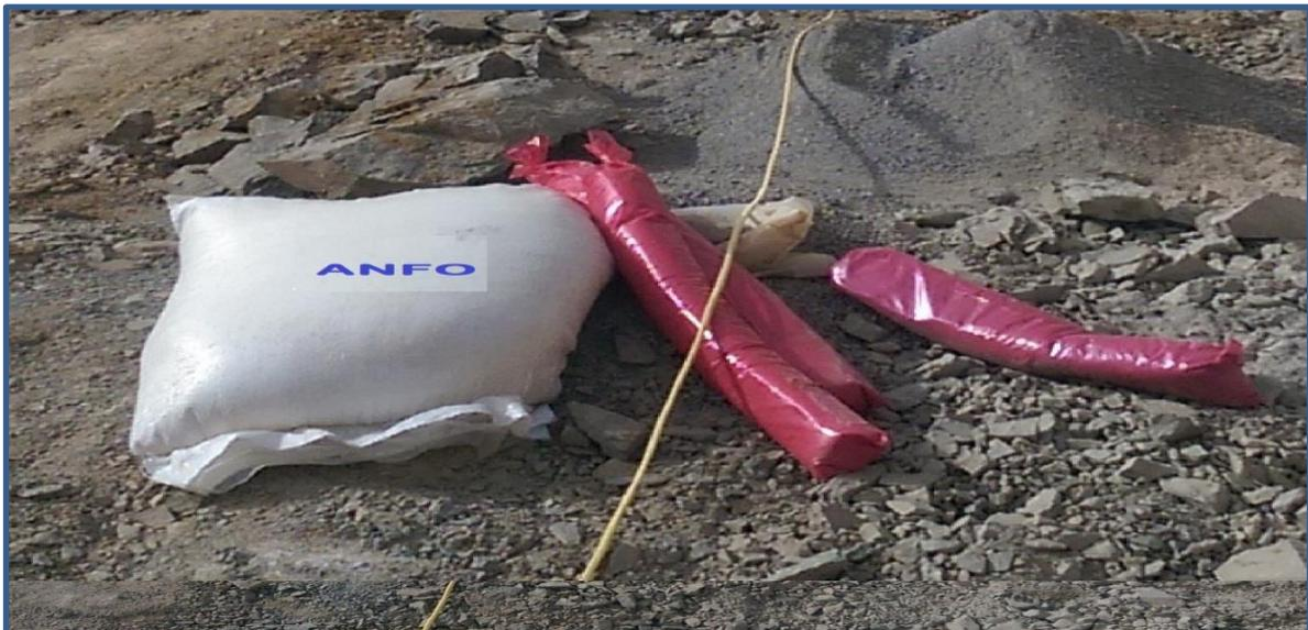
**Figure III.6** : La charge de colonne (ANFOMIL).
