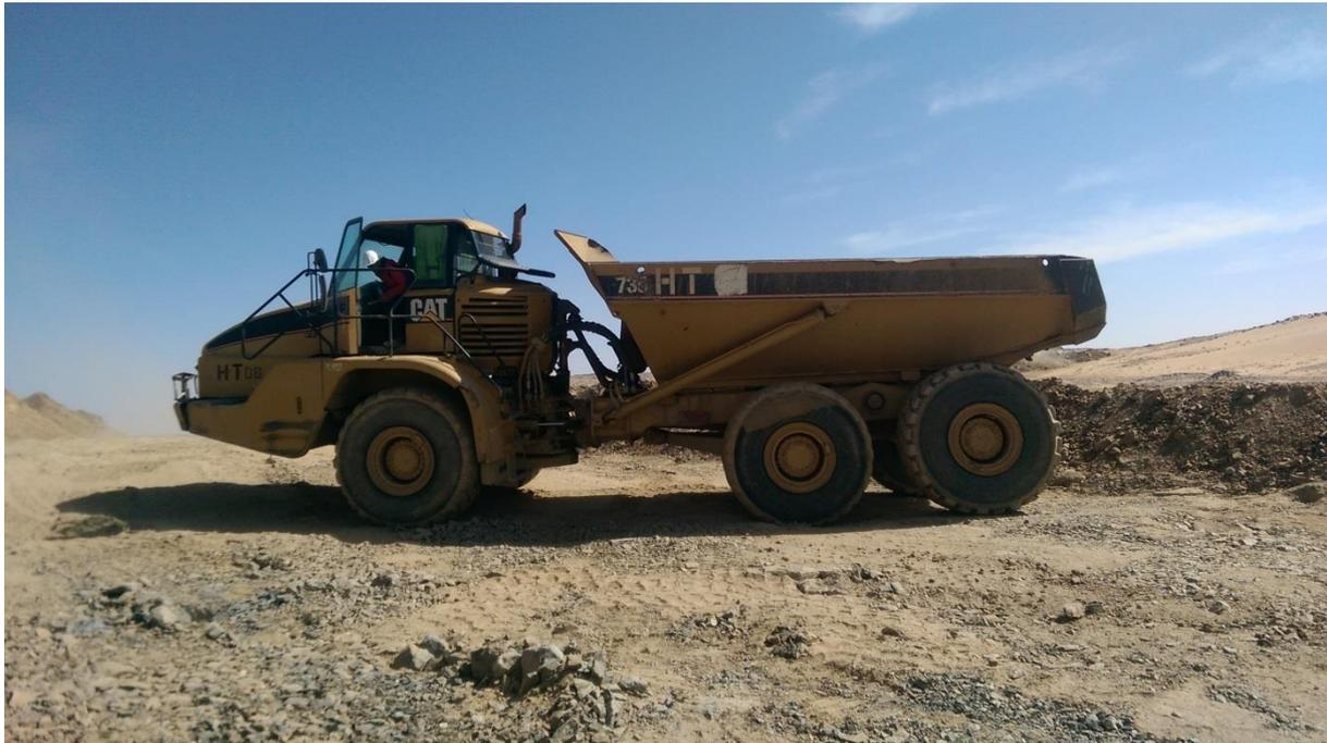
**Figure III.9** : Dumper articulé CATERPILLAR 735 (photo prise le 4/03/2019)
