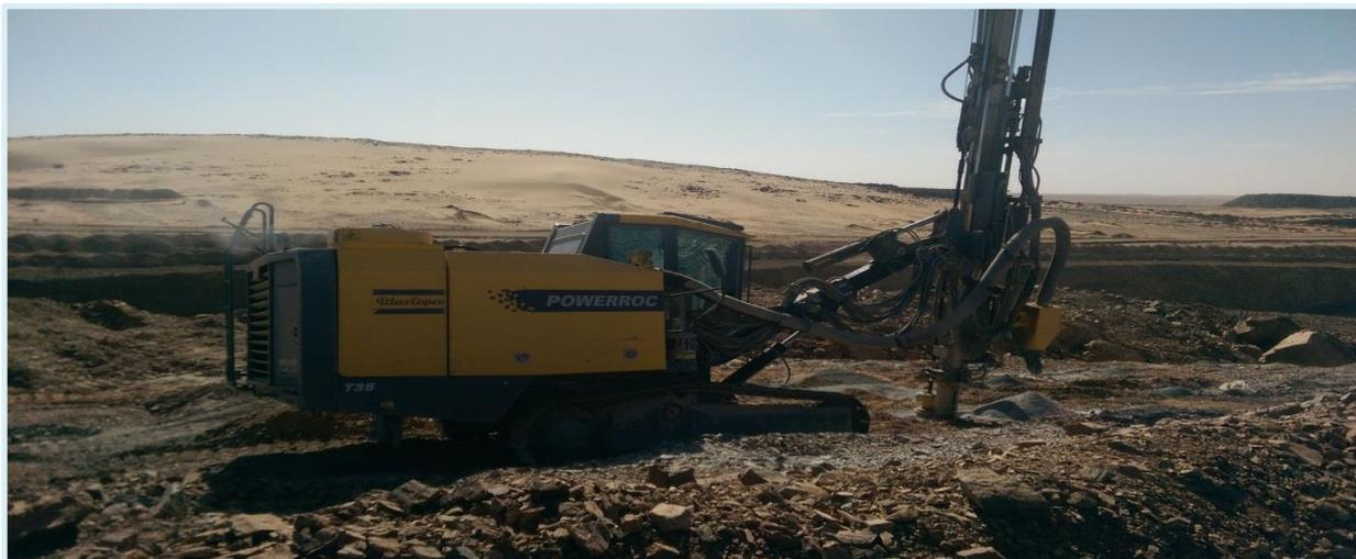
**Figure III.4 : la sondeuse ATLAS COPCO PowerROCT35**
