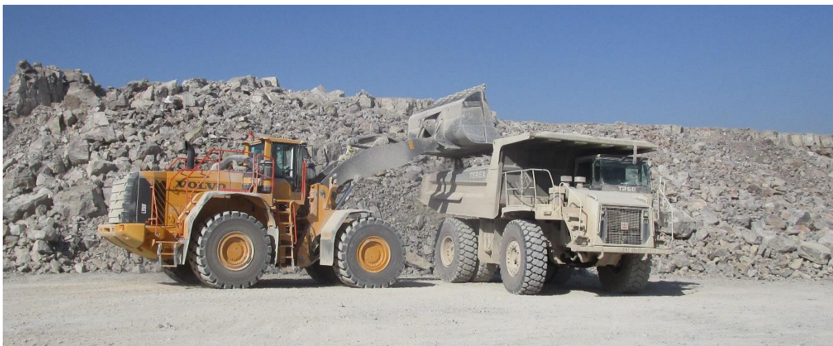
Fig. II.8 Processus de chargement au niveau de la carrière
