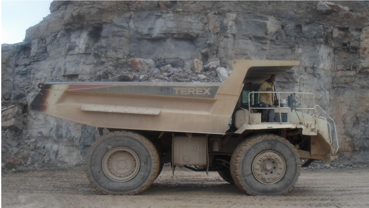
Fig. II.9 Présentation du camion TEREX TR60
