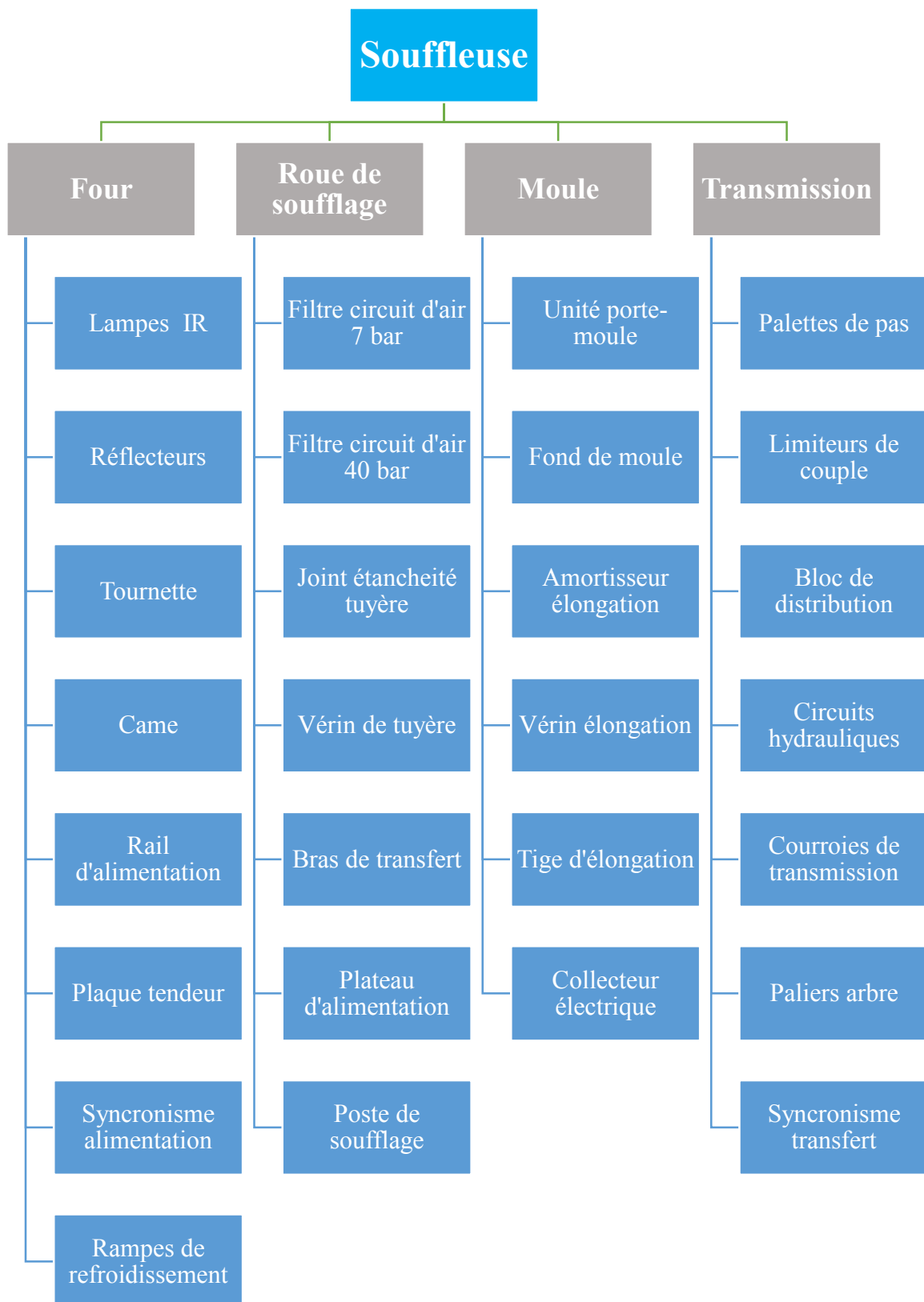
Figure IV.2: Schéma de décomposition de la souffleuse SBO 10[11].
