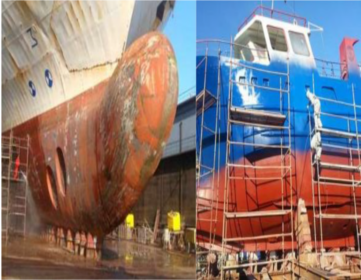
Figure 1 : image représentative de traitement de surface d'une coque d'un bateau.
