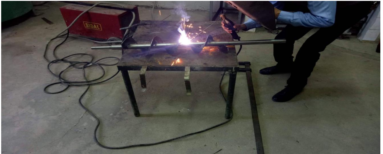
Figure IV.9 Soudage de l'ensemble arbre/hélice.
