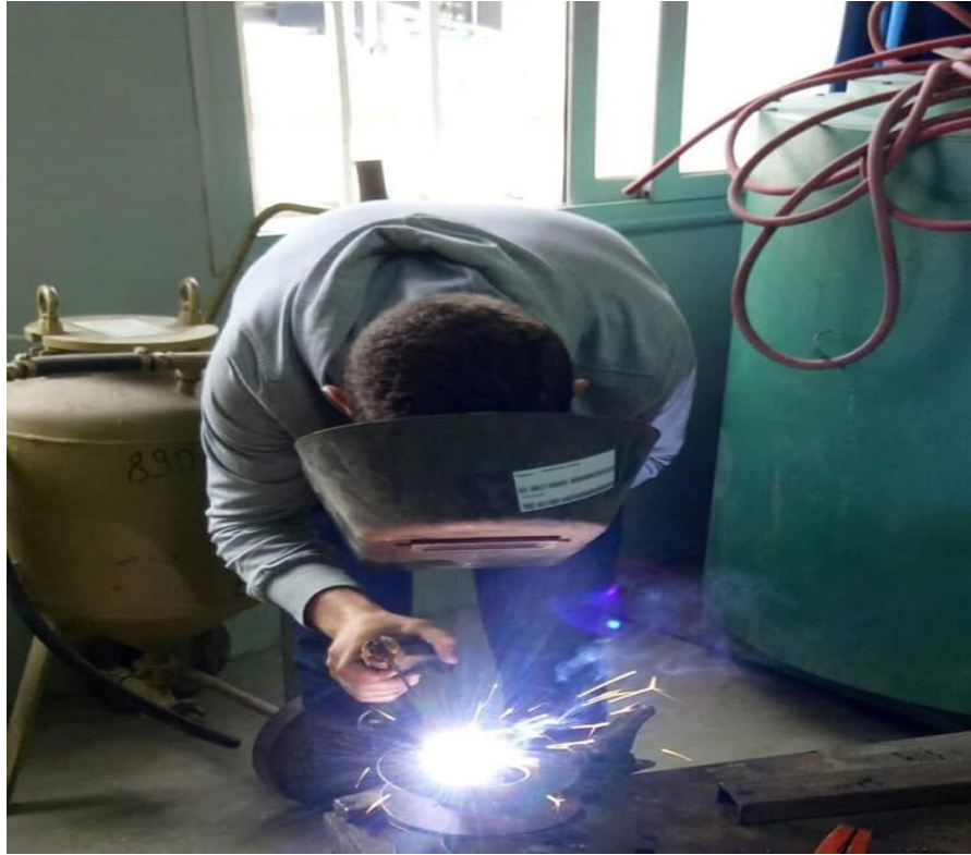
Figure IV.6 Assemblage des disques avec soudage
