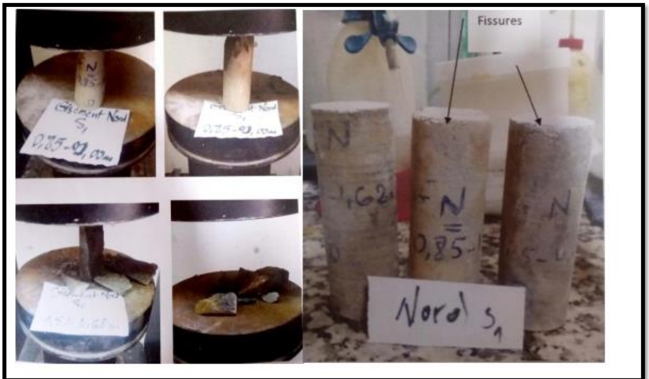
Figure IV.6: L'essai de la résistance à la compression simple. [28]
