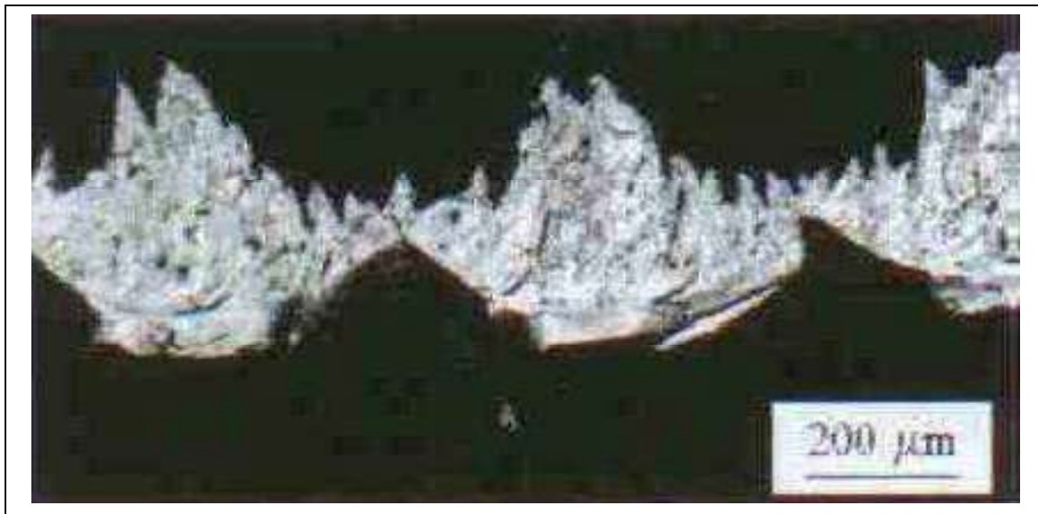
Figure I.17 : Copeau d'acier inoxydable de géométrie continue (Outil cermet, V_c = 300 m/min, f = 0,05 mm/tr)
