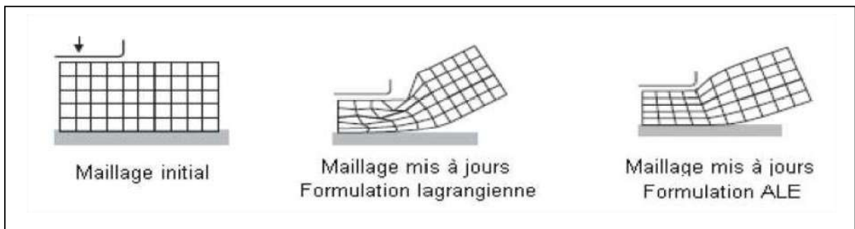
Figure I.21 : Difficultés associées aux Formulation Lagrangienne et réparation ALE [14]
