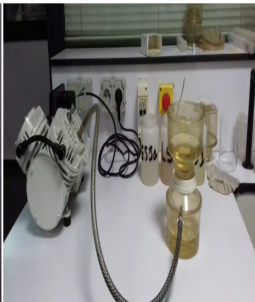
Figure 09 : Photographie d'une pompe sous vide
