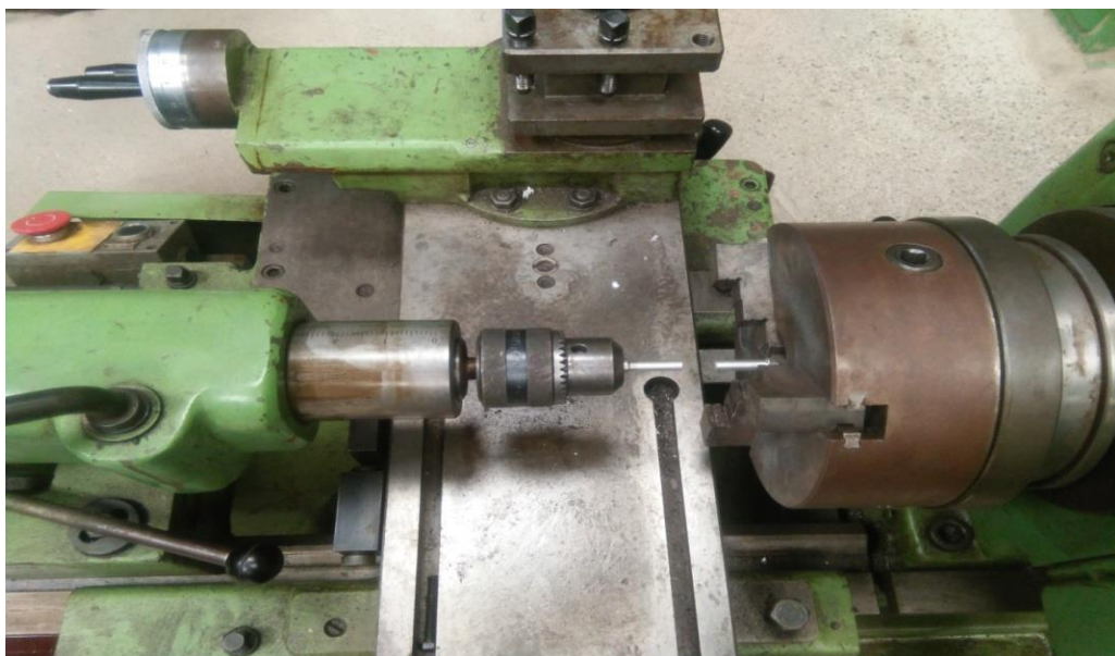
Figure III-7 : Image qui montre la fixation des deux pièces à souder
