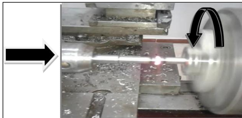
Figure III-9 : Image Montrant deux pièces mises en contact l'une à l'autre avec une force de friction F_1 .
