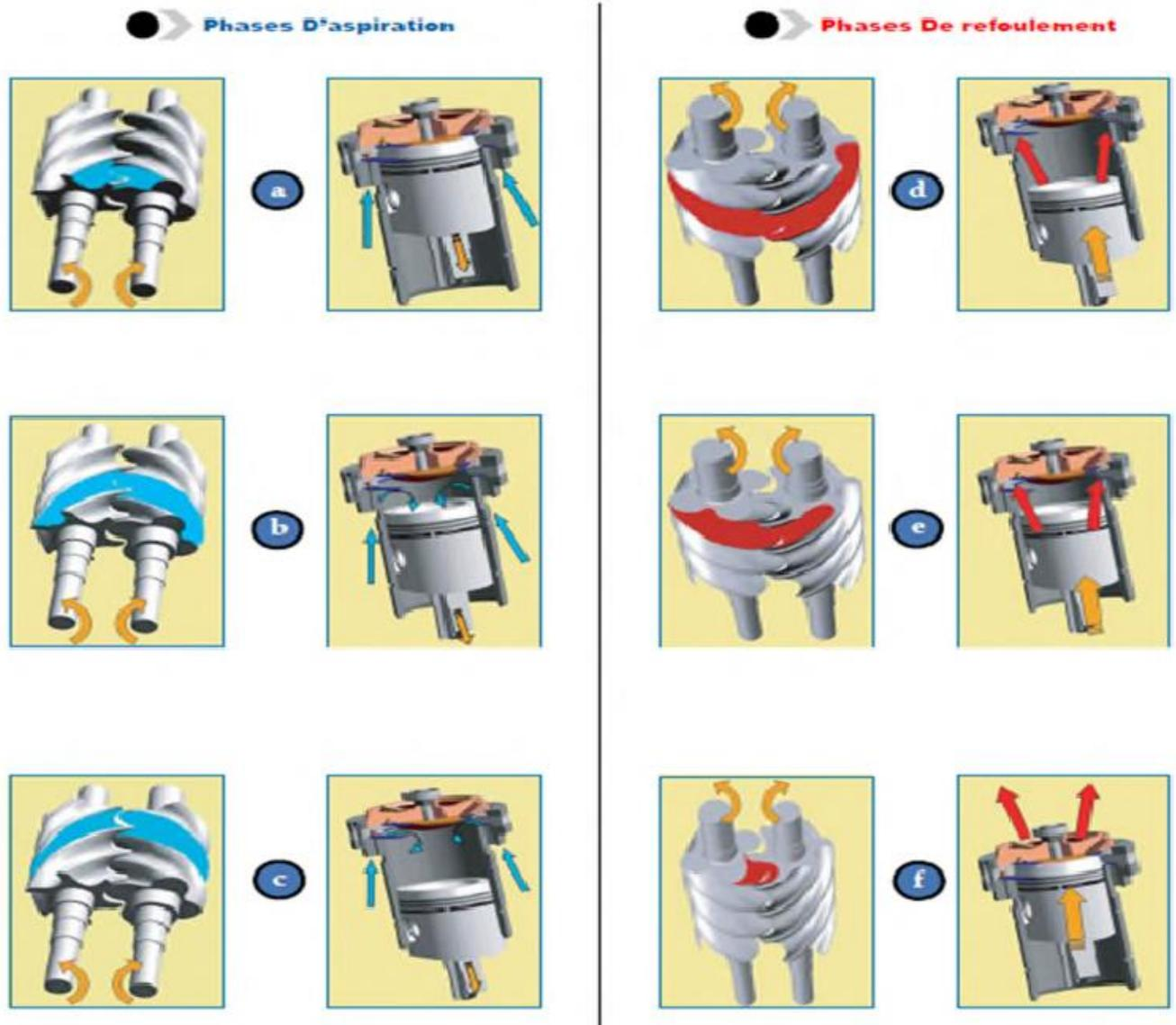
Figure I.7: Les phases de compresseur à vis. [7].
