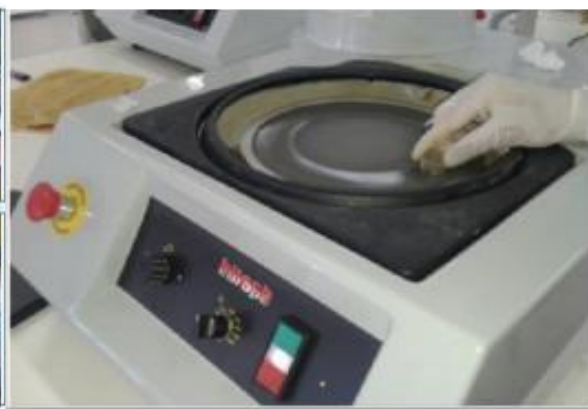
Figure III.16 : Machine pour le polissage Figure III.17 : L'opération de polissage
