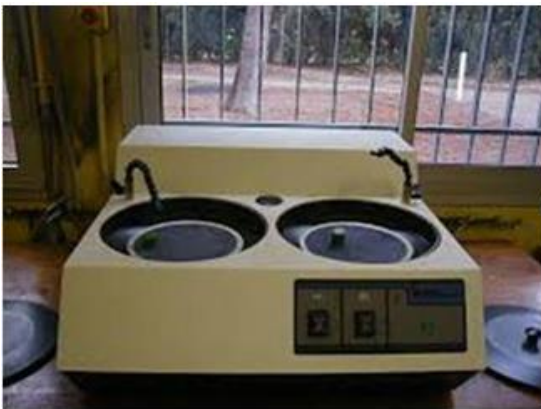
Figure III.16 : Machine pour le polissage Figure III.17 : L'opération de polissage
