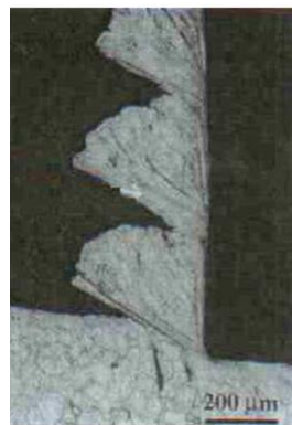
Figure I.16 Copeau discontinu d'un acier austénitique inoxydable usiné avec un outil carbure ( V_c = 130\text{m/min} , f = 0,1\text{mm/tr} ). [7].
