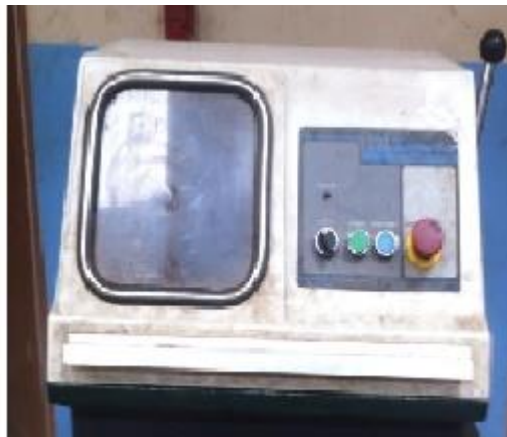
Figure III.10 : L'opération de découpage Figure III.11 tronçonneuses avec lubrifiant
