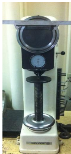
Figure III.21: machine d'essai de dureté universel (micro duromètre)
