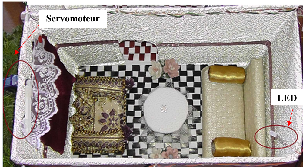
Figure IV.14: Montage réel de servomoteur
