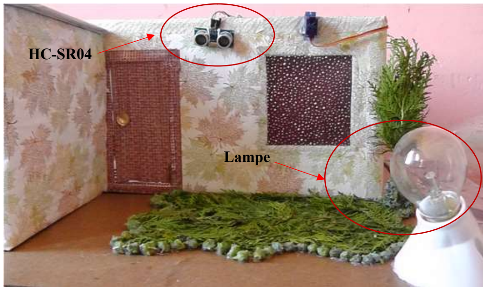
Figure IV.19: Montage réel de système d'éclairage
