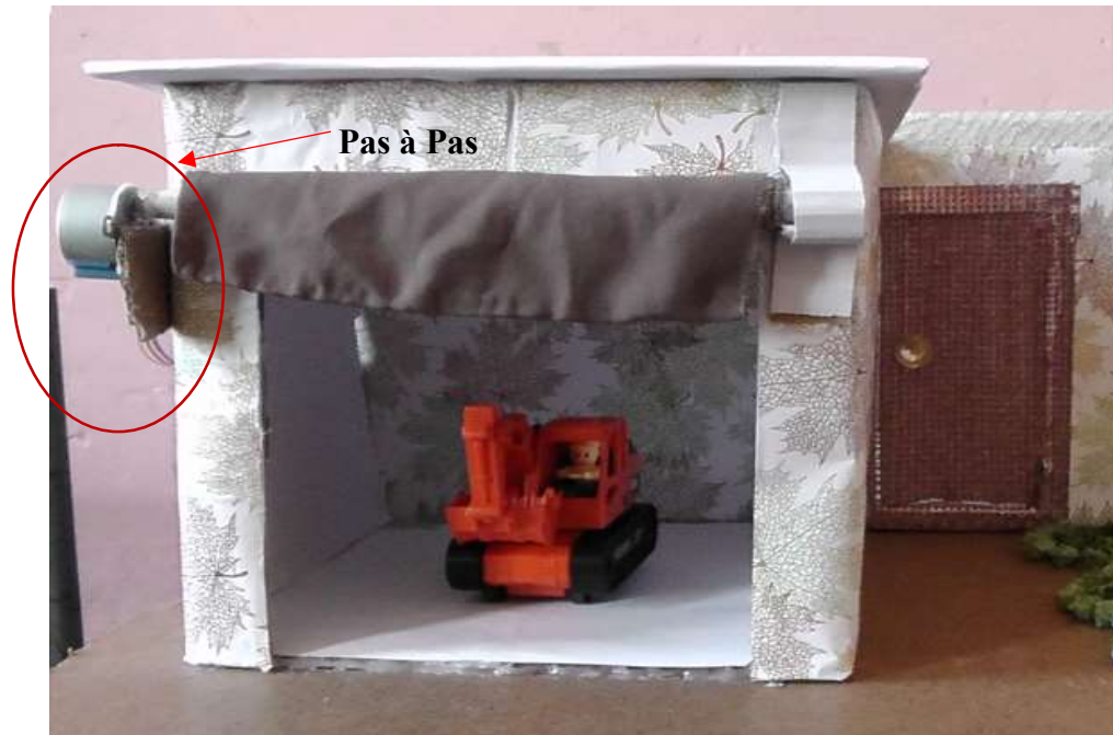
Figure IV.2: Montage réel de moteur pas à pas
