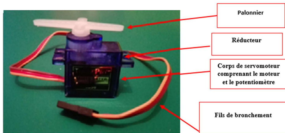
Figure III.23: Les composants de servomoteur
