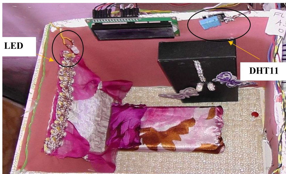
Figure IV.11: Montage réel de capteur DHT11
