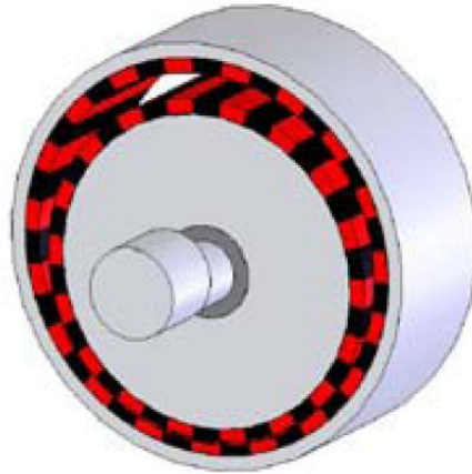
Figure I. 15 Engrenage magnétique harmonique plus pratique [RAH7]
