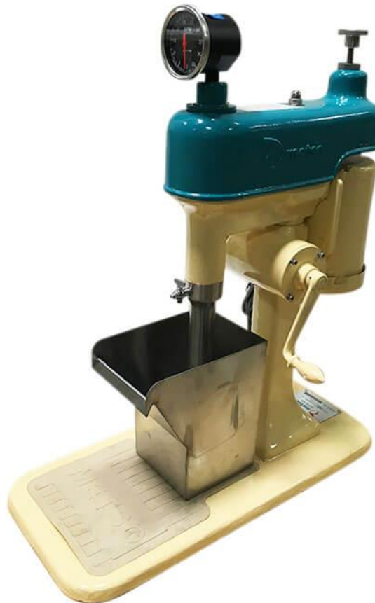
Figure II.2 : Machine de flottation, modèle D-1
