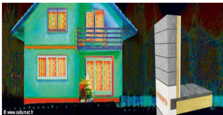
Figure I.9 Exemple sur les ponts thermiques (en orange).
