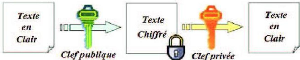
Figure I.5 Chiffrement asymétrique.
