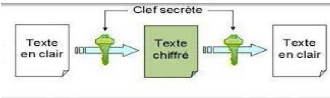
**Figure I.4 Chiffrement symétrique.**
