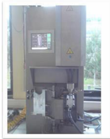
Figure IV.23 : Photos de la mini extrudeuse bis- vis co-rotative
