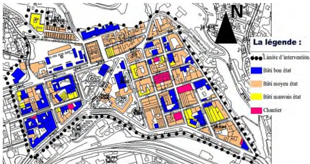
Figure 30: Etat du bâti Source : Auteur, 2021
