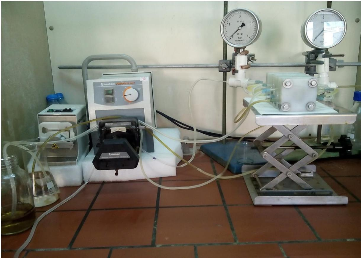
**Figure V.1.** Système d'extraction utilisé pour l'extraction du Cr (VI) par le contacteur membranaire.
