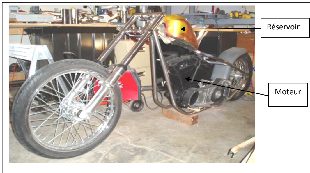
Figure I.11: Montage du moteur et le réservoir [3].
