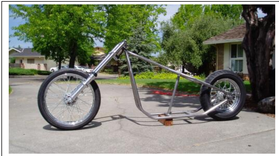
Figure I.10: Prototype d'un cadre moto assemblé [3].
