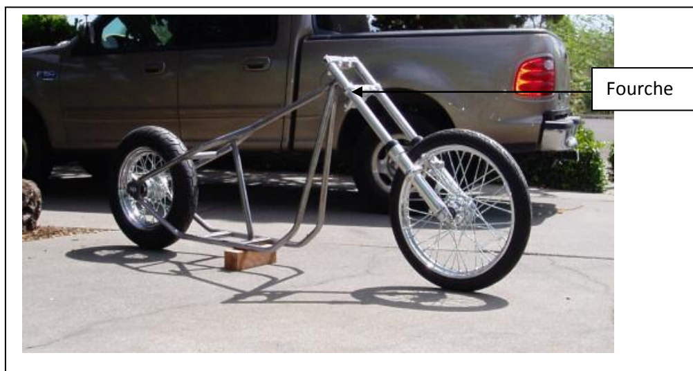
Figure I.9: Assemblage fourche, roue, et cadre moto [3].
