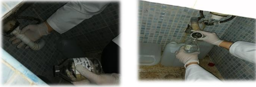
Figure 03 : Prélèvement de l'eau contenue dans les siphons des lavabos.
