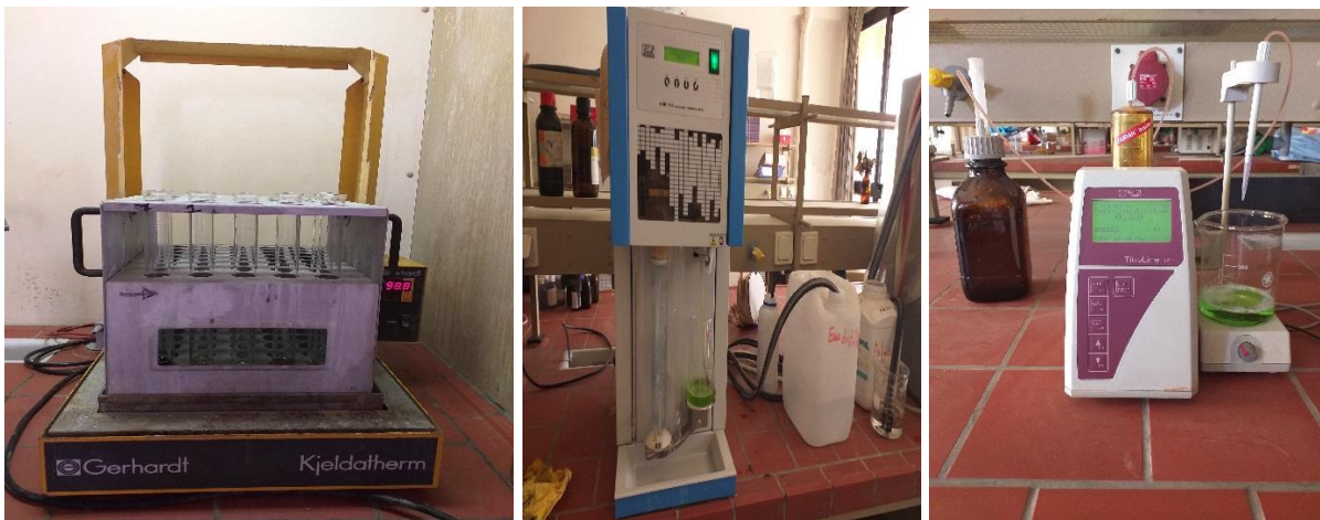
Figure 28 : Photographie représentant les trois étapes du dosage de l'azote total
