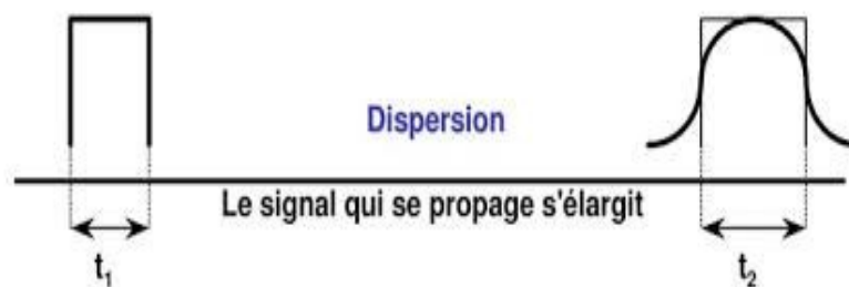
Figure III.6 : La dispersion d'une fibre optique.
