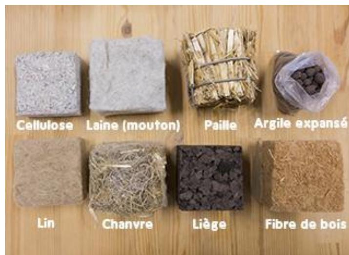
**Figure I.20:** les types des isolants (Source : [www.ecoconso.be.com](http://www.ecoconso.be.com) )
