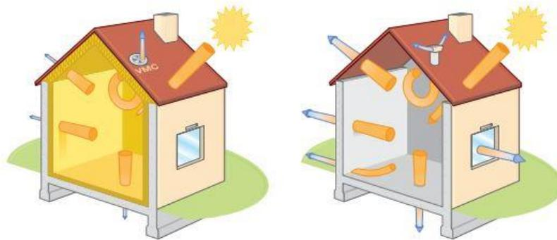
**Figure I.15:** les déperditions thermiques dans un bâtiments isolée et non isolée
