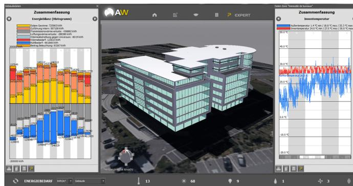
**Figure II.17:** la simulation thermique dynamique par l'utilisation de logiciel archizard
