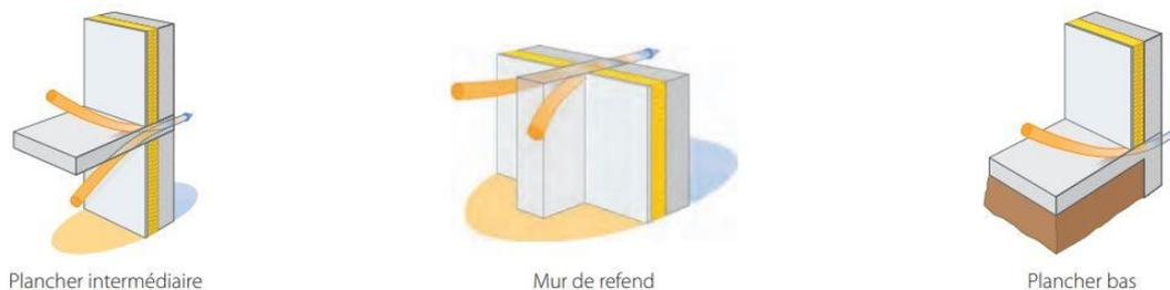
**Figure I.12:** les différents ponts thermiques linéaires (Source : [www.saint-gobain.com](http://www.saint-gobain.com))
