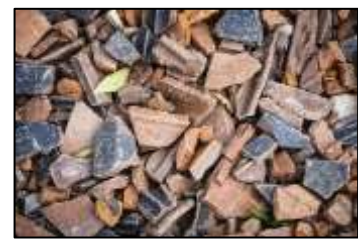
Figure 31: Revêtement de sol a partir des tuiles concassées
