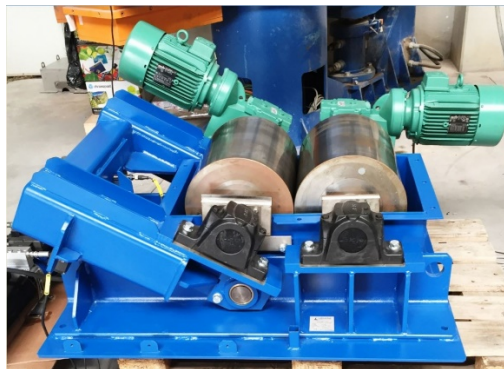
Fig I.13 Broyeur à cylindre.
