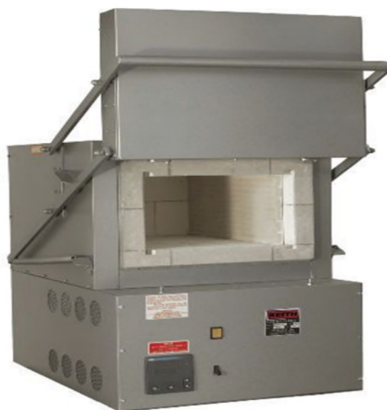
Figure II.2 : Four de traitement thermique de l'université de Bejaia.
