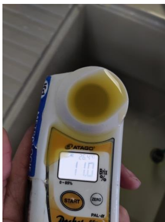
Figure II.5. Détermination du Brix d'un jus IFRUIT
