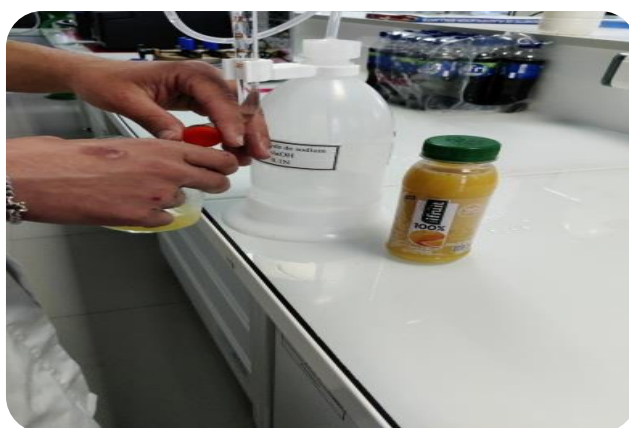
Figure II.4. Détermination de l'acidité titrable d'un jus IFRUIT
