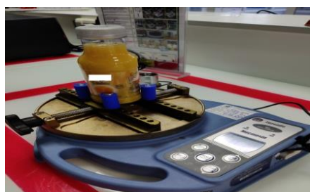
Figure II.8. Mesurer du couple de serrage et d'ouverture d'une bouteille de jus ifruit
