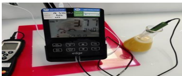
Figure II.3. Détermination du pH du jus IFRUIT
