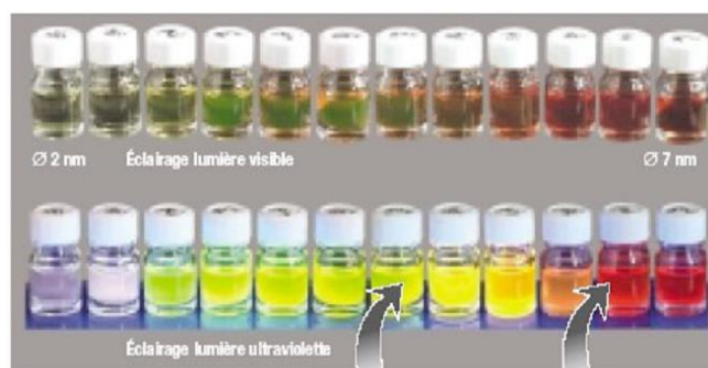
Figure 8: Solutions contenant des nanocristaux fluorescents classés par éclairés : en haut, par de la ordre de taille croissante, lumière visible ; en bas, par un rayonnement ultraviolet [5].
