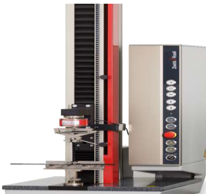
Figure II.2 : Photographie de la machine de traction utilisée (Zwick Roell Z 0.5)
