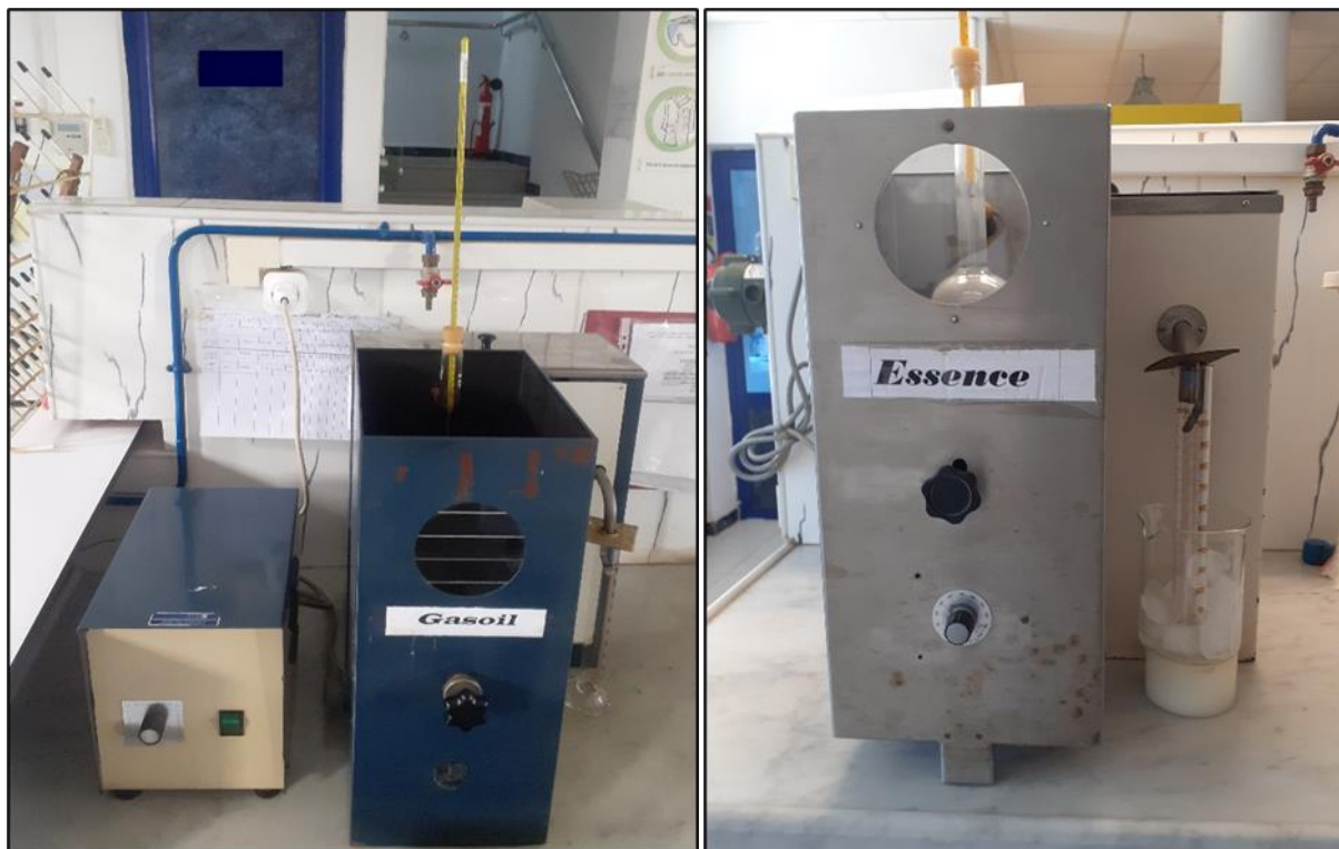
Figure III.4 : Appareillage de la distillation de l'essence sans plomb et du gasoil ASTM D86
