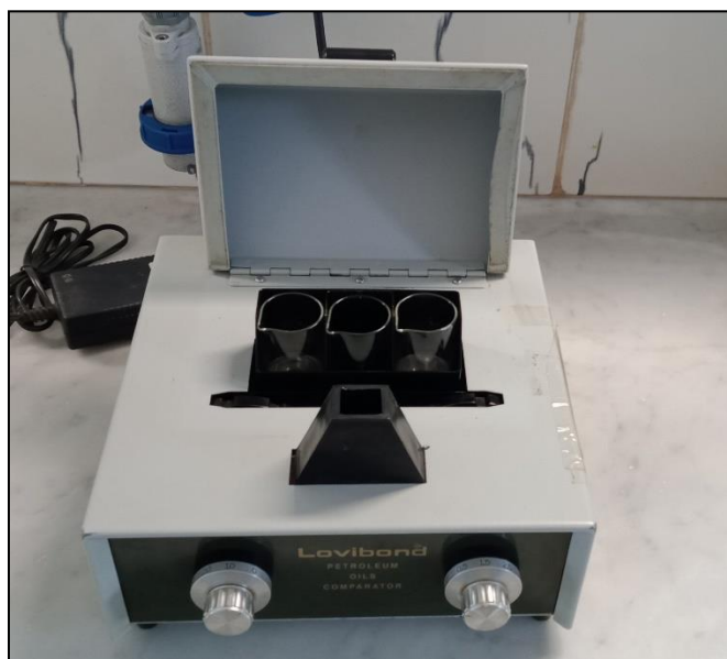
Figure III.8: Appareillage de Colométrie ASTM D 1500
