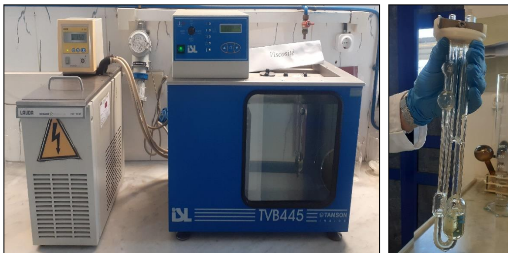
Figure III.6 : Appareillage de la viscosité cinématique à 20°C ASTM D445
