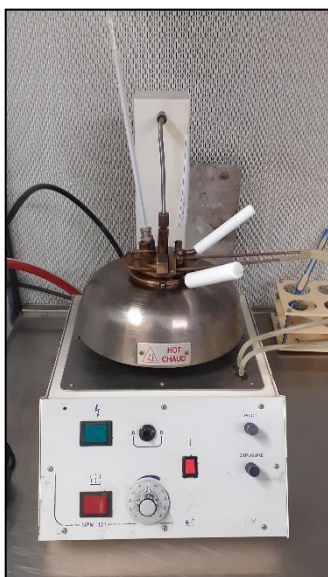
Figure III.9: Appareil de PENSKY MARTENS pour la mesure du point éclair ASTM D 976
