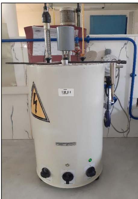
Figure III.11 : Appareil de mesure de la corrosion ASTM D 130
