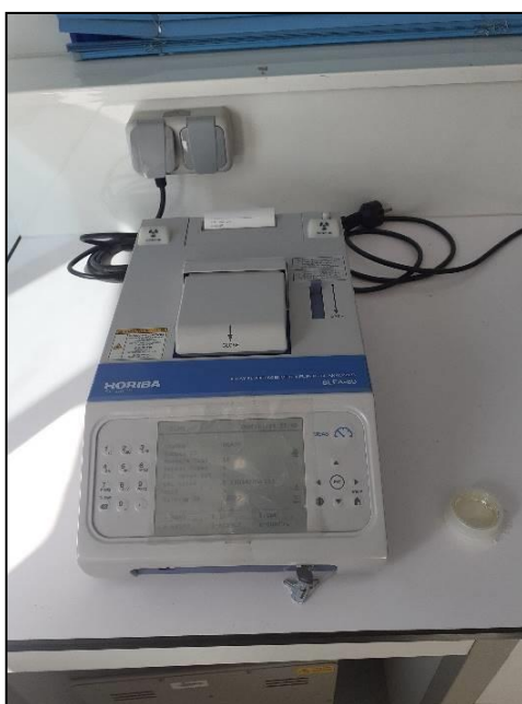
Figure III.14 : Appareillage de la teneur en soufre ASTM D 4294
