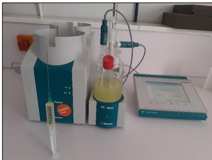
Figure III.10: Appareillage de la teneur en eau ASTM D1744
