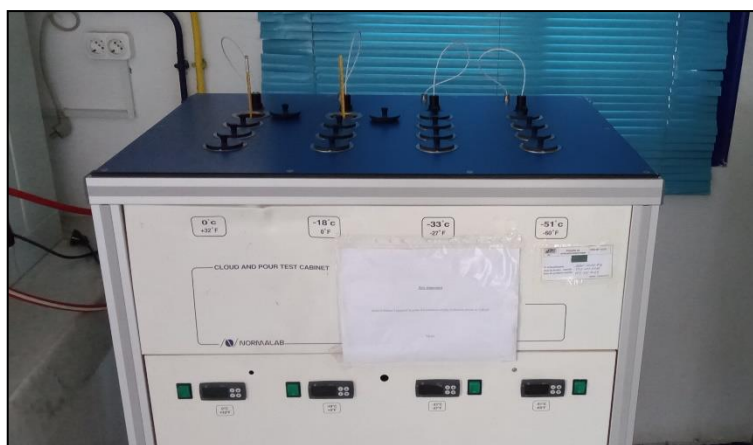
Figure III.7 : Appareil de mesure du point d'écoulement ASTM D 97
