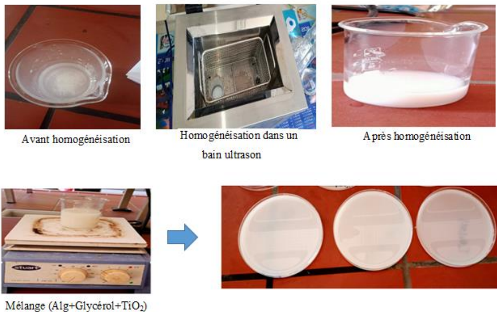
Figure 30 : Procédé de fabrication des films d'alginate de sodium et jus d'ail
