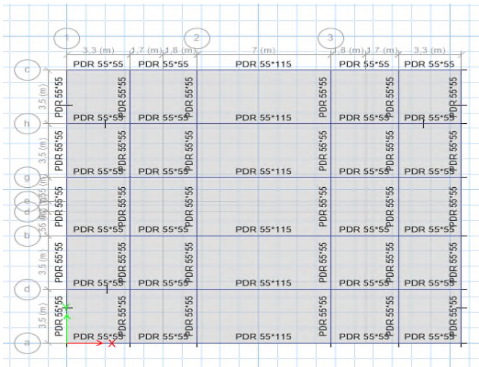
Figure VI.8. Repérage des poutres de rigidité
